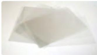
Tanto o papel vegetal, laser filme e a transparência laser são utilizados para a confecção do negativo **utilizando impressora laser.**
