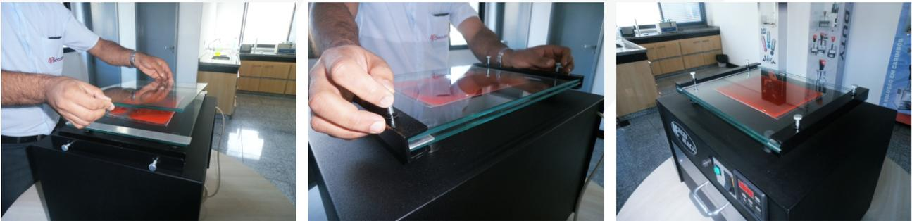
Você notará que um pouco de resina sairá para fora das tiras de espuma, isso é normal e indica que você colocou resina demais; porém, deverá impedir que a resina escorra para dentro da máquina, se isto acontecer abra a montagem, limpe e comece novamente. Depois que tudo estiver fixado no seu devido lugar, você está pronto para começar o processo de exposição.
